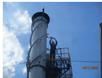
รูปที่ 1 ปล่อง Hot Oil Parameter : TSP, SO 2 , NO x , CO
